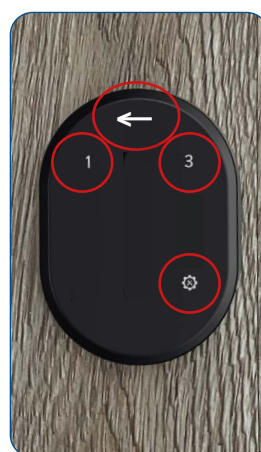
Tylko klawisze 1, 3 i prawy klawisz menu / klawisz ustawień są podświetlane. Strzałka na wyświetlaczu wskazuje naprzemiennie lewy i prawy kierunek
