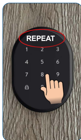
Gdy na wyświetlaczu pojawi się słowo REPEAT, ponownie wprowadź 5-cyfrowe hasło użytkownika
