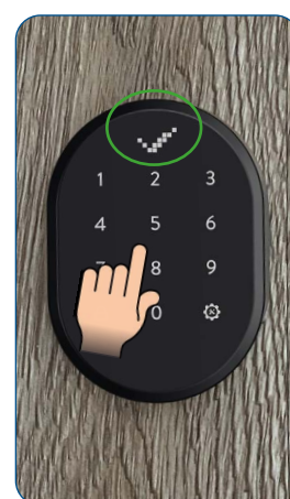
Wprowadź 5-cyfrowe hasło master po czym na wyświetlaczu pojawi się symbol V
