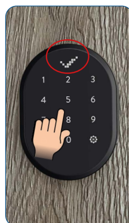
Umieść palec master nad czujnikiem lub wprowadź 5-cyfrowe hasło master po czym na wyświetlaczu pojawi się symbol V
