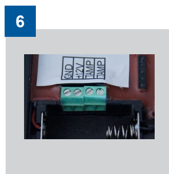
Alternatywnie: Podłącz do zewnętrznego źródła zasilania
